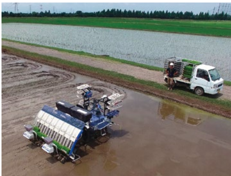
監視のもとに稲の苗を植え付けるロボット田植え機
