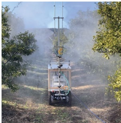
モバイルムーバーによる農薬散布
